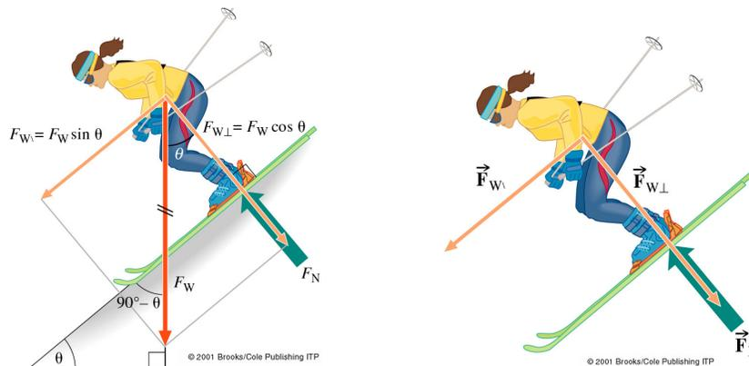
Figure 4.3: Un corps sur un plan incliné. La composante du poids parallèle au plan incliné entraîne le corps vers le bas du plan. La composante du poids normale au plan est équilibrée par la réaction normale du plan. L'application de la deuxième loi de Newton dans la direction du plan donne  $\sum F_{\parallel} = F_{p\parallel} = ma_{\parallel}$ .
