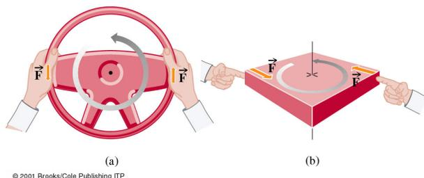
Figure 8.10: (a) Deux forces antiparallèles et de même module agissant en deux points différents d'un corps, ne produisent pas un équilibre bien que  $\sum \vec{F} = 0$ . En effet, il y a un moment de force et le système ne peut pas être en équilibre rotationnel. (b) Le bloc tourne sans subir un mouvement de translation.
