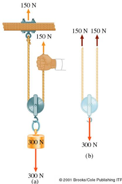
Figure 8.2: (a) Dans cette configuration, la poulie est utilisée comme un multiplicateur de force. Comptez le nombre de tronçons de cordes supportant la charge; dans ce cas, il y en a deux. Le système peut donc supporter une charge double de la force exercée. Ainsi la main soulève une charge de 300 N en exerçant une force de 150 N. (b) La tension dans chaque partie de la corde est 150 N. La force ascendante totale est donc 300 N.
