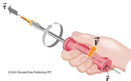
Figure 8.7: La règle de la main droite et du tournevis. Une vis ordinaire avance lorsqu'elle est tournée dans le sens des doigts de la main droite.
