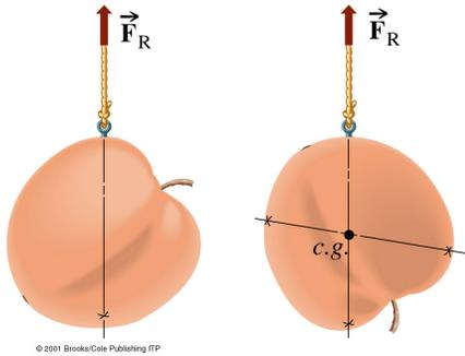
Figure 8.13: La position du c.g. d'un objet peut être déterminée en le suspendant en des points différents. Le c.g. est toujours sur la ligne d'action de la force soutenant l'objet en équilibre.
