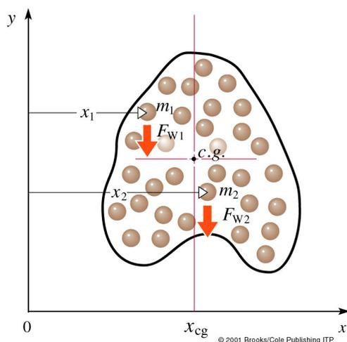
Figure 8.12: La somme des moments, autour d'un point  $O$  arbitraire, des poids de toutes les masses ponctuelles constituant un corps est égale au moment de force du poids total du corps agissant au c.g. Mesurée dans la direction de l'axe des  $x$ , la position du c.g. est à  $x_{c.g.}$ . Mesurée dans la direction de l'axe des  $y$ , la position du c.g. est à  $y_{c.g.}$ .
