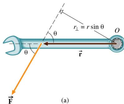
Figure 8.6: La torsion qu'on peut effectuer avec une clé dépend du module de la force, de la direction de sa ligne d'action et du point où elle est appliquée; c'est le moment de la force. Le moment d'une force est donné par la formule  $F r_{\text{perp}} = F_{\perp} r = F r \sin \theta$ .
