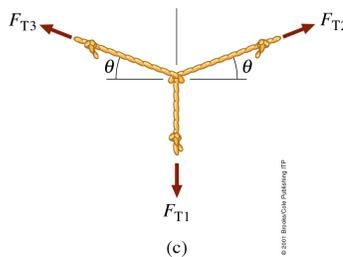
(a) Le diagramme du corps isolé montre que les trois forces externes  $F_{T2}$ ,  $F_{T3}$  et  $F_W$  sont concourantes au noeud. La tension  $F_{T1}$  vient du poids du moteur:
