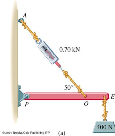
Une enseigne pesant 40 kg est suspendue à l'extrémité d'une barre légère, qui est attachée à un mur par un pivot. La barre est tenue par une corde sous un angle de  $50^\circ$ . La tension sur la corde est de 0.70 kN. La barre a une longueur totale de 2.00 m et la corde est attachée à 0.50 m de son extrémité. Quelle est la force de réaction sur le pivot au mur en P ( $g = 10 \text{ m/s}^2$ )?
