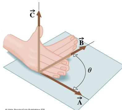
Figure 8.8: Pour trouver la direction du produit vectoriel  $\vec{A} \times \vec{B}$ , on place les doigts de la main droite dans la direction de  $\vec{A}$  et on les fait tourner de l'angle  $\theta$  pour coïncider avec la direction de  $\vec{B}$ ; alors le pouce est dans la direction du produit vectoriel  $\vec{C} = \vec{A} \times \vec{B}$ .
