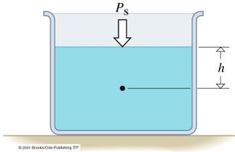
Considérons maintenant un réservoir ouvert, avec un timbre-poste d'aire  $A$  immergé parallèlement à la surface d'un liquide de masse volumique  $\rho$  à une profondeur  $h$ . La face supérieure du timbre est soumise, de la part du liquide, à une force normale vers le bas égale au poids d'une colonne de fluide de volume  $V = Ah$ , de masse  $m = \rho Ah$  et d'un poids  $F_W = mg = \rho Ahg$  au dessus du timbre.
