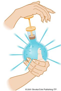
Figure 14.4: Un pulvérisateur aérosol contient un gaz sous pression appelé propulseur. Il pousse vers le bas sur la surface du liquide à pulvériser. Quand la soupape est ouverte, l'extrémité supérieure du long tube est à la pression atmosphérique et son extrémité inférieure est à une pression bien supérieure. La différence de pression propulse le liquide vers le haut et de là vers l'extérieur.
