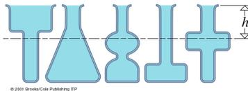
La pression à une profondeur donnée est indépendante de la forme du récipient. Elle dépend que de la masse volumique du liquide  $\rho$  et de la profondeur  $h$ . NB:  $h$  est mesuré parallèlement à la direction de la pesanteur.
