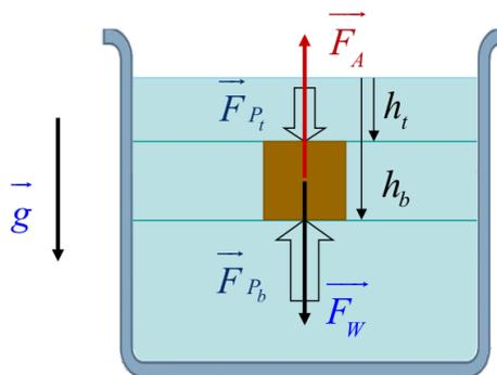
Considérons un cube immergé dans l'eau, comme montré à la figure 14.7. Considérons que le cube a une surface  $A$  et hauteur  $\Delta h$ . La face supérieure de l'objet est soumise à une pression  $P_t = \rho_l g h_t$ , où  $\rho_l$  est la masse volumique du liquide. La face inférieure est soumise à une pression  $P_b = \rho_l g h_b$ . On sait qu'une pression  $P$  génère une force  $F = PA$  sur une surface  $A$ . Donc la force nette  $F_A$  sur l'objet due à l'action de la pression est:
