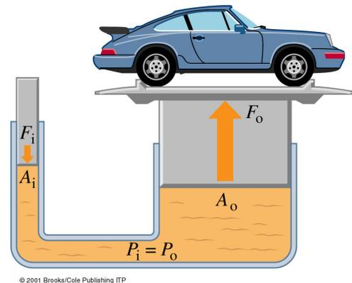
NB: On parle d'un multiplicateur de force et non d'un multiplicateur de travail. Il y a conservation de l'énergie mécanique: le travail de la force  $F_i$  est égal au travail de la force  $F_0$ . Ça veut dire que pour un déplacement  $dl_i$  du piston  $i$  et un déplacement  $dl_0$  du piston 0:
