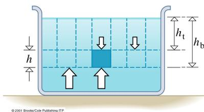
Prenons un élément de volume  $dV$  de petite hauteur  $dh$  immergé à une profondeur  $h$  dans un fluide, ayant une surface d'aire  $A$ .  $P$  est la pression qui agit sur la face supérieure et  $P + dP$  celle sur la face inférieure. La pression du fluide sur le volume exerce une force  $F = PA$  vers le bas et une force  $F = (P + dP)A$  vers le haut. La seule autre force qui agit sur  $dV$  est la force de gravitation,  $dF_W$ , qui correspond au poids de l'élément de volume:
