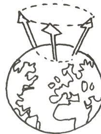
Figure 4.18: Applications de la loi de conservation du moment cinétique: la stabilité gyroscopique. (Ref: La physique en BD , ed. Larousse.)
