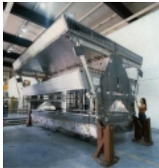
Le détecteur de muons est constitué de 80 chambres à fils de 7 m<sup>2</sup> de surface en moyenne. La trace d'un muon (particule qui interagit peu avec la matière) est mesurée avec une précision de 30 microns.
