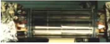
Le détecteur micropistes de silicium contient 72672 canaux de lecture. Il est le détecteur le plus proche du point d'interaction et le plus petit détecteur de L3. Il mesure les traces avec une précision de l'ordre de 10 microns.
