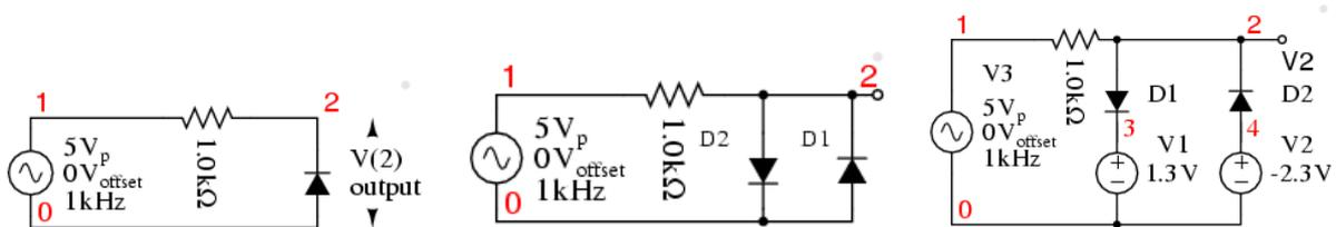
Figure 6: Circuits écrêteurs.
