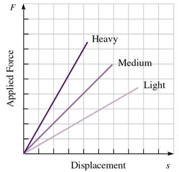
Une force  $F$  appliquée à un ressort l'étire et déplace son extrémité de  $s$ . La figure est une représentation graphique de  $F$  en fonction de  $s$  pour trois ressorts différents. La pente de chaque courbe est la constante d'élasticité,  $k$ , du ressort. Plus le ressort est rigide, plus la valeur de  $k$  est grande.
