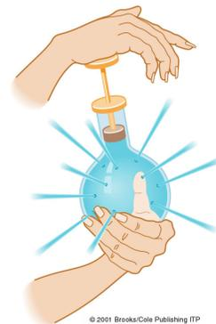
Figure 7.5: Un pulvérisateur aérosol contient un gaz sous pression appelé propulseur. Il pousse vers le bas sur la surface du liquide à pulvériser. Quand la soupape est ouverte, l'extrémité supérieure du long tube est à la pression atmosphérique et son extrémité inférieure est à une pression bien supérieure. La différence de pression propulse le liquide vers le haut et de là vers l'extérieur.
